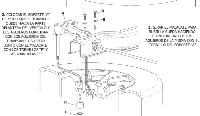
4. COLOCAR DESDE ABAJO LA TUERCA "B" Y AJUSTARLA CON LA LLAVE DE SEGURIDAD "C" PRECAUCIÓN: GUARDAR LA LLAVE DE SEGURIDAD EN EL BOLSO PORTAHERRAMIENTAS
