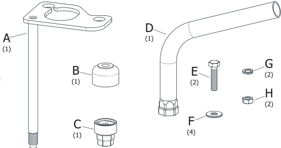
1. BAJAR LA RUEDA, REEMPLAZAR LOS TORNILLOS ORIGINALES QUE SUJETAN EL MALACATE POR LOS TORNILLOS "E" Y LAS ARANDELAS "F" Y "G", COLOCAR DESDE ABAJO EL SOPORTE "A" DE MODO QUE EL TORNILLO QUEDE HACIA LA PARTE DELANTERA DEL VEHÍCULO Y AJUSTARLO CON LAS ARANDELAS "F" Y LAS TUERCAS "H"
