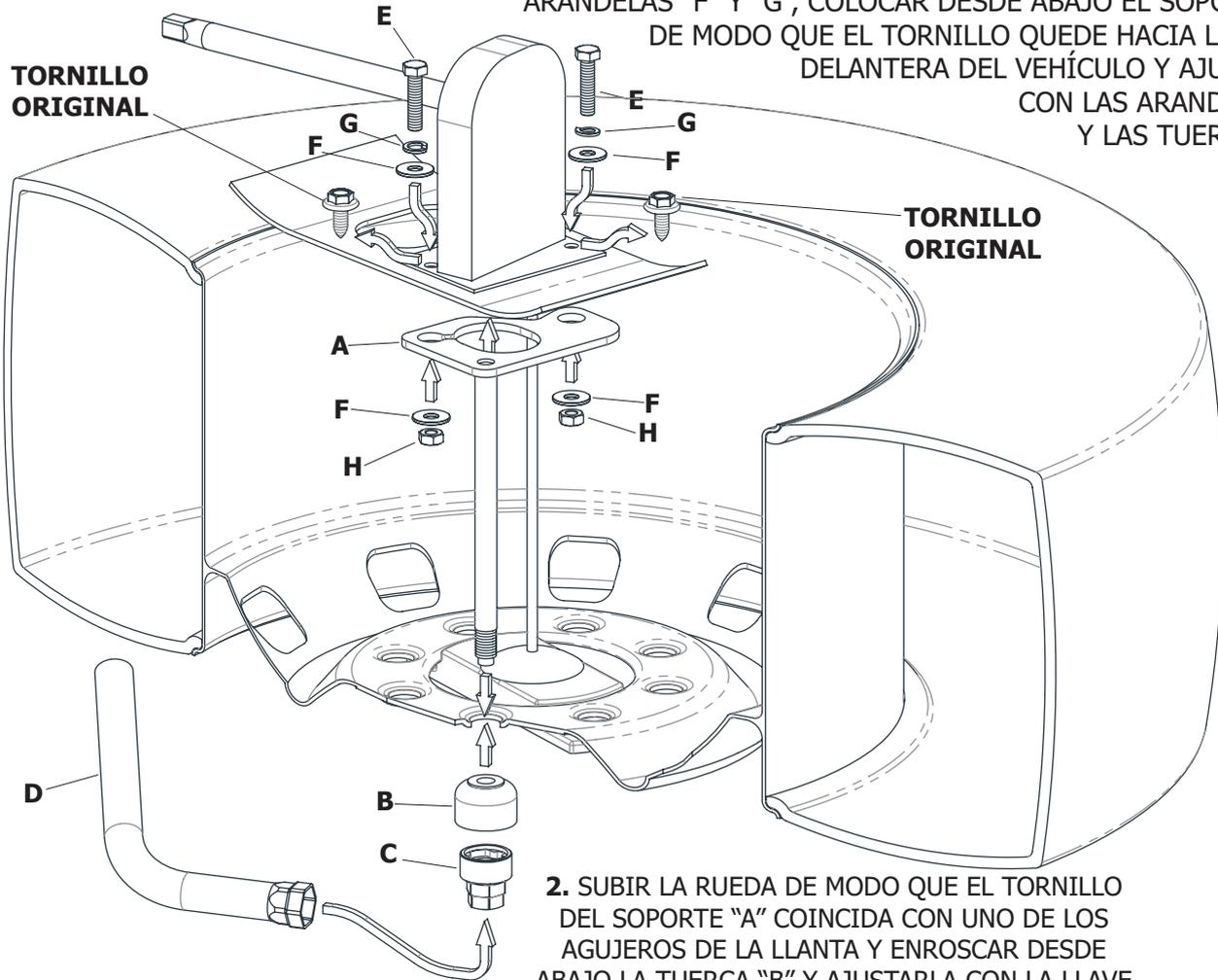
2. SUBIR LA RUEDA DE MODO QUE EL TORNILLO DEL SOPORTE "A" COINCIDA CON UNO DE LOS AGUJEROS DE LA LLANTA Y ENROSCAR DESDE ABAJO LA TUERCA "B" Y AJUSTARLA CON LA LLAVE "C", UTILIZANDO EL TUBO LLAVE "D"
