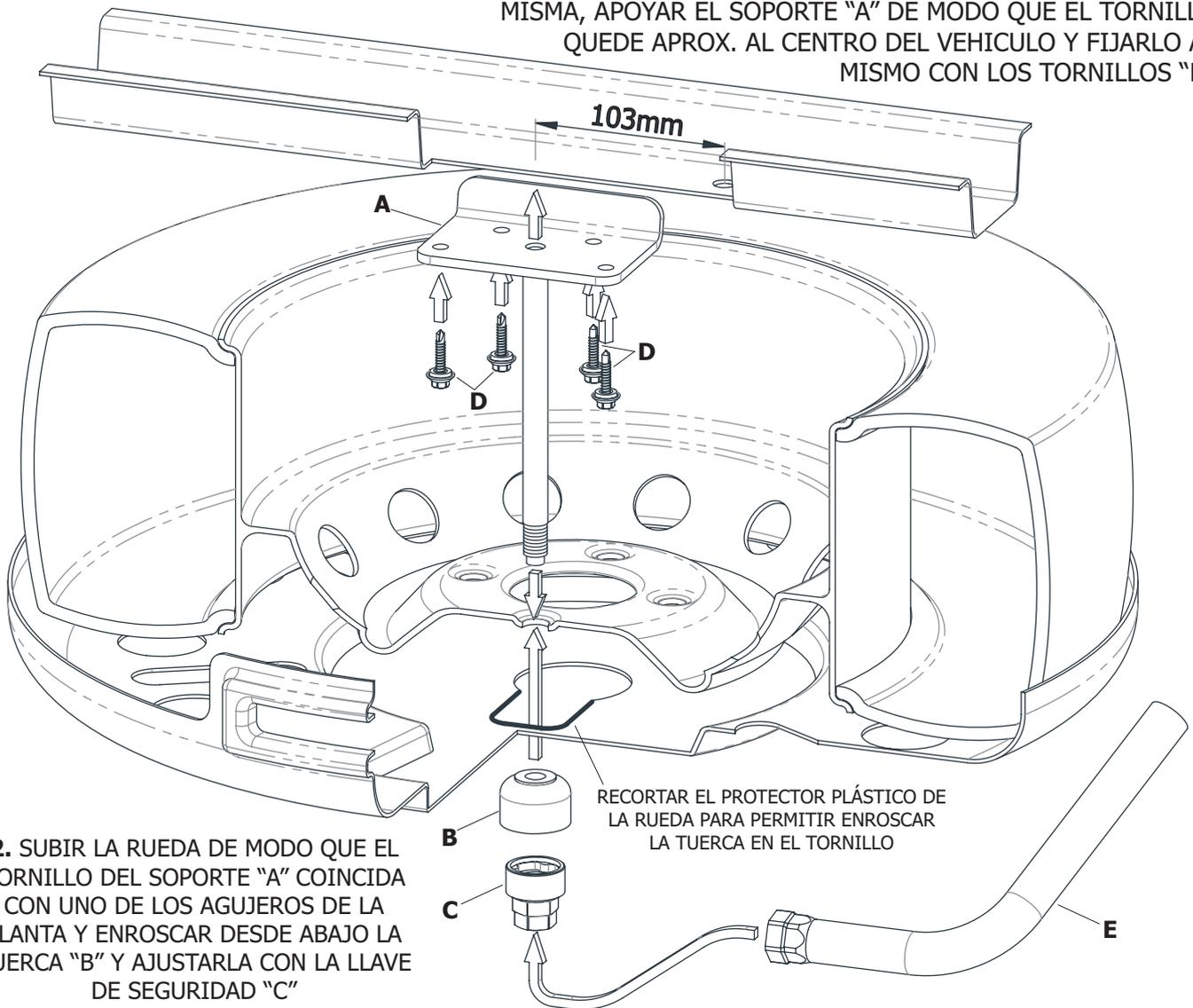
**2. SUBIR LA RUEDA DE MODO QUE EL TORNILLO DEL SOPORTE "A" COINCIDA CON UNO DE LOS AGUJEROS DE LA LLANTA Y ENROSCAR DESDE ABAJO LA TUERCA "B" Y AJUSTARLA CON LA LLAVE DE SEGURIDAD "C"**
