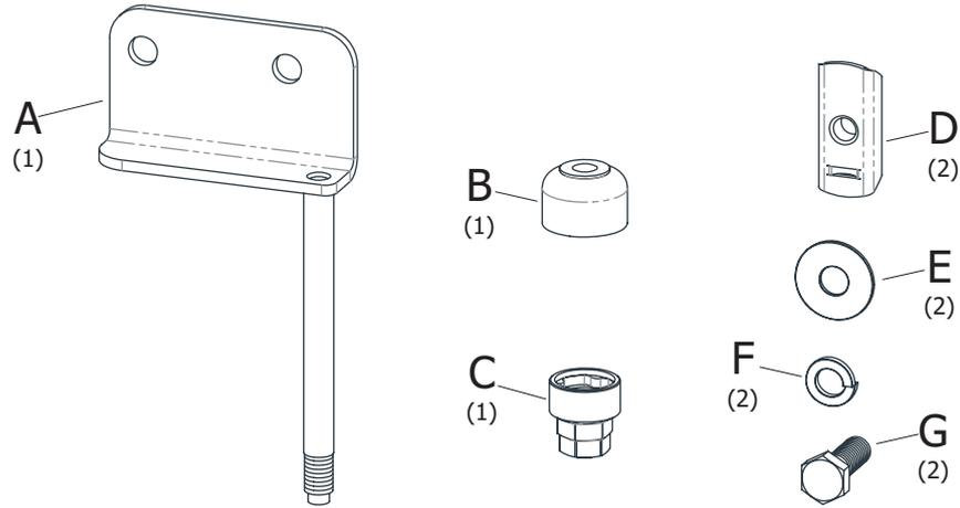
**1.** BAJAR LA RUEDA Y APOYAR EL SOPORTE "A" DE MODO QUE EL TORNILLO QUEDE HACIA LA PARTE DELANTERA DEL VEHÍCULO
